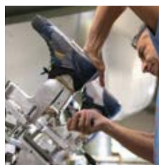
7 INIEZIONE SUOLA Sole injection / Einspritzen der Sohle
