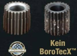
Test EN ISO-20623/ASTM D2266 zeigte, dass X1 weißes Fettspray mit BoroTecX™ Standard-Fettspray um bis zu ein vierfaches übertrifft.
