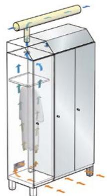
Unsere ZBL Technologie: hohe Luftwechselrate durch Anbindung an bauseitige Lüftungsanlagen.
