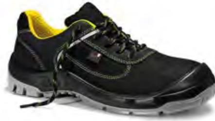
Leder/Textilmaterial; Atmungsaktives Textilfutter; Geschlossene, gepolsterte Lasche; Stahlkappe; Ganzflächige Einlegesohle; Metallfreier Durchtrittschutz; PU/PU Sohle NEW BASIC; PU-Spitzenschutz
