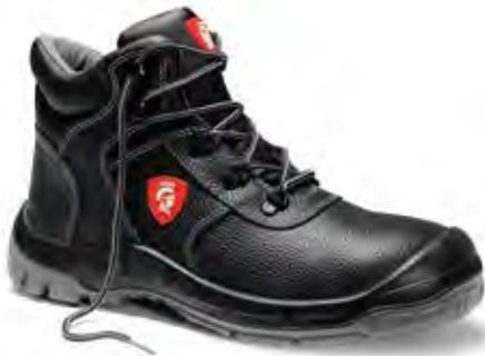
Rindleder; Atmungsaktives Textilfutter; Geschlossene, gepolsterte Lasche; Stahlkappe; Ganzflächige Einlegesohle; Antistatische Softvlies-Brandsohle; PU/PU Sohle NEW BASIC; PU-Spitzenschutz
